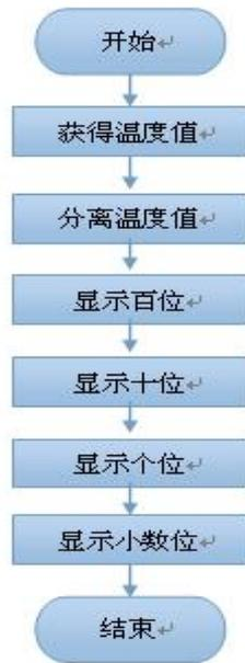
图 4-3 温度显示程序框图
