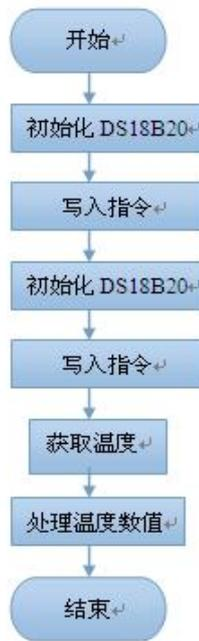
图 4-2 温度检测程序框图
