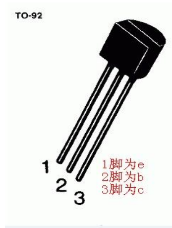
图 3-9 三极管引脚介绍
